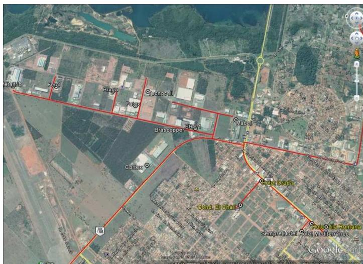
Figura 7 – Ramal Distribuição baixa pressão jusante ERS-1 Núcleo Industrial - T.Lagoas
