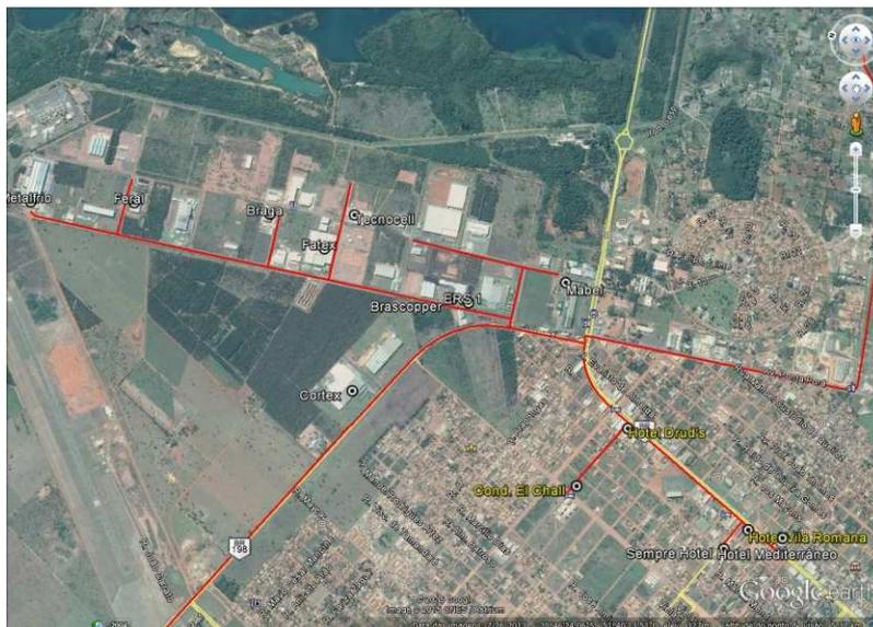
Figura 7 – Ramal Distribuição baixa pressão jusante ERS-1 Núcleo Industrial - T.Lagoas
