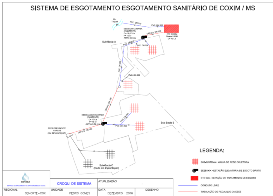
Croqui do processo do Sistema de Esgotamento Sanitário de Coxim.
