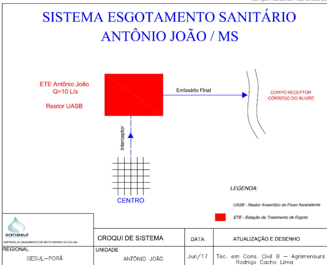
Fluxograma do processo do Sistema de Esgotamento Sanitário de Antônio João.
