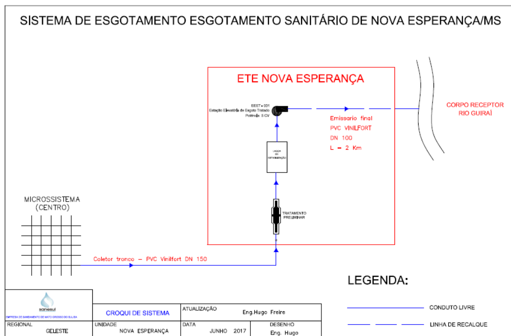
Croqui do Sistema de Esgotamento Sanitário do Distrito de Nova Esperança
