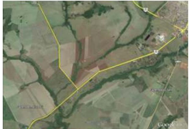
Fig. 1 - Ramal de Distribuição de alta pressão em Campo Grande a cerca, na faixa de domínio da estrada vicinal, seguindo até a Usina Termelétrica William Arjona, onde está a Estação de Medição e Redução de Pressão - EMRP do cliente com DN 8".
