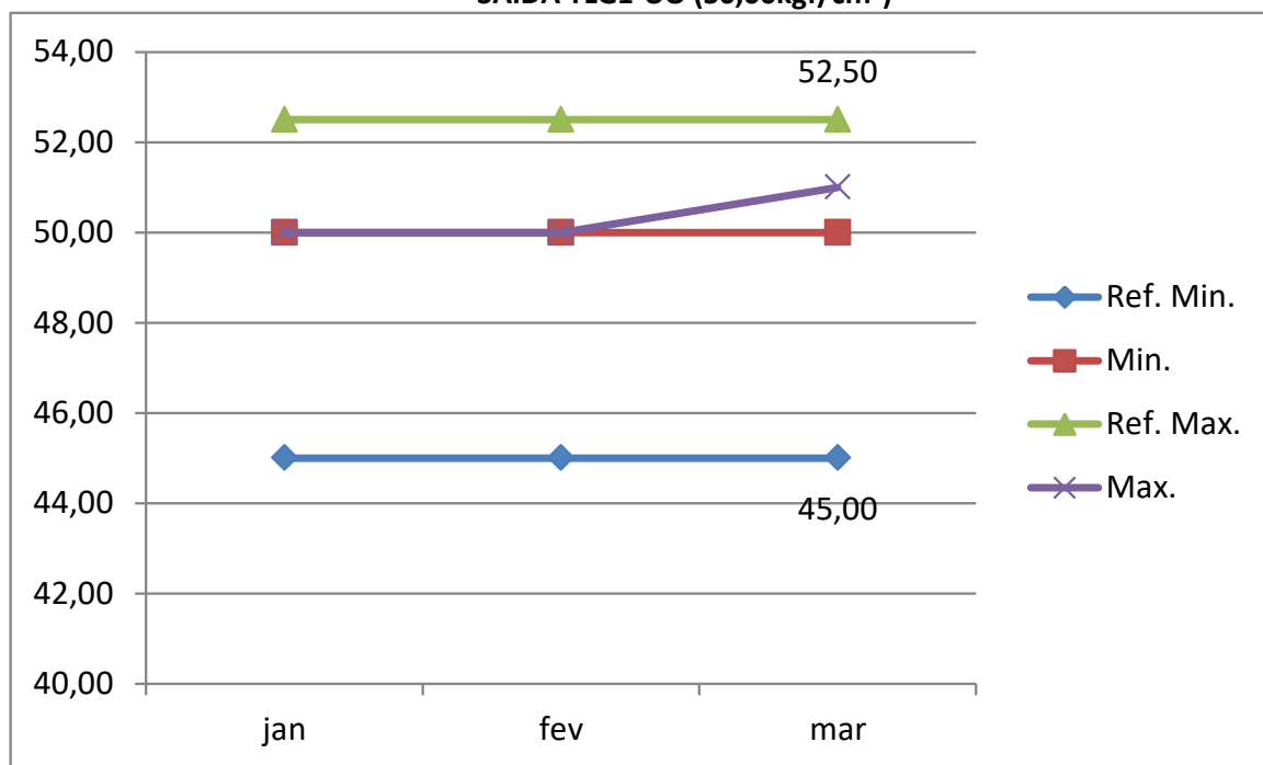
Gráfico 11: Pressão de gás na saída da Estação de Odorização (UO)
