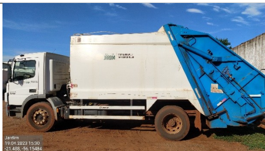
Figura 2 - Veículo coletor com capacidade de 12 m 3 .
