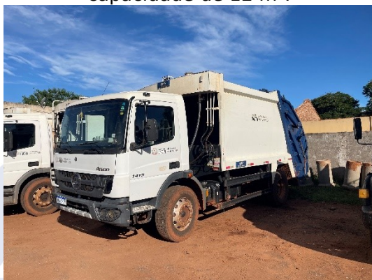
Figura 3 - Veículo coletor com capacidade de 12 m 3 .
