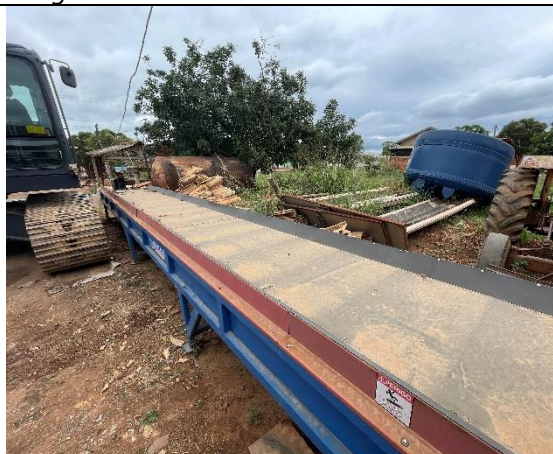
Figura 11 – Esteira de triagem, armazenada a céu aberto.
