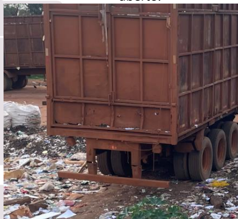
Figura 7 – Detalhe das condições da base do veículo de Semirreboque para transporte de rejeitos.
